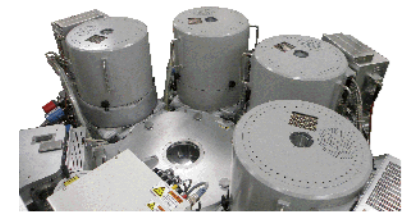
量産対応のシリコン深掘り装置 (CPX ASE-Predeus)
